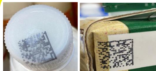
Смещение кода маркировки при печати
