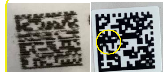
Смазывание кода маркировки или его отдельных элементов
