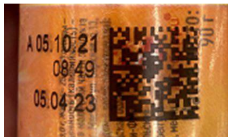
Печать кода маркировки на бликующей/светоотражающей поверхности
